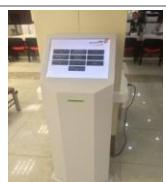
Терминал сенсорный 19", с термопринтером.
